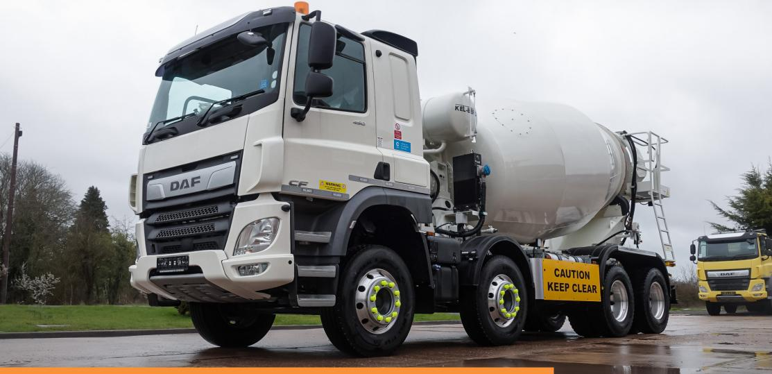
**KEL-BERG TRANSIT CONCRETE MIXER**  **KBM/3/32 8M<sup>3</sup> MIXER DAF SLEEPER INSTALLATION**
